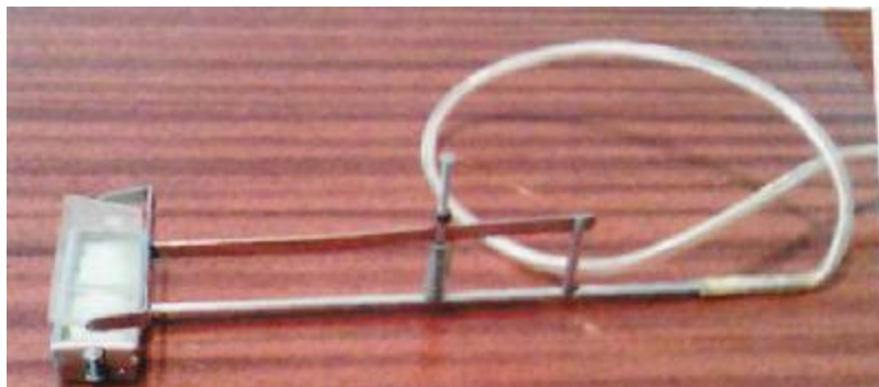
Рис. 1. Аппарат прижизненной ангиоскопии и измерения кровяного давления в сосудах шовной полосы полых органов
