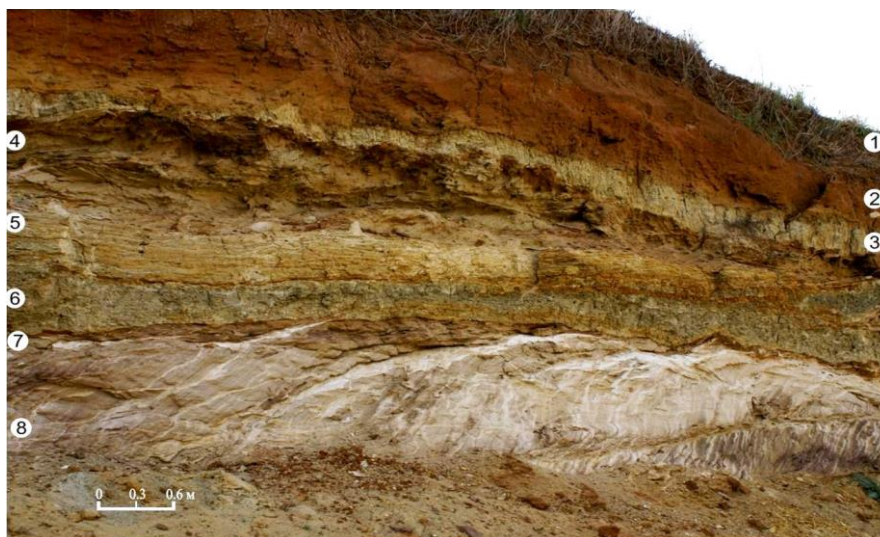
Рис. 3. Буглен, новый песчаный карьер, стенка карьера: 1 – почвенно-растительный слой; 2 – песчанистые рыхлые отложения, пропитанные гидроокислами Fe; 3 – светлые глинистые породы; 4 – песчанистые породы; 5 – светлые глинистые породы; 6 – глины зеленоватого цвета; 7 – ожелезненные песчанистые породы; 8 – тонкослоистые песчаники интенсивно трещиноватые, трещины заполнены белым рыхлым кварцевым материалом – песком
